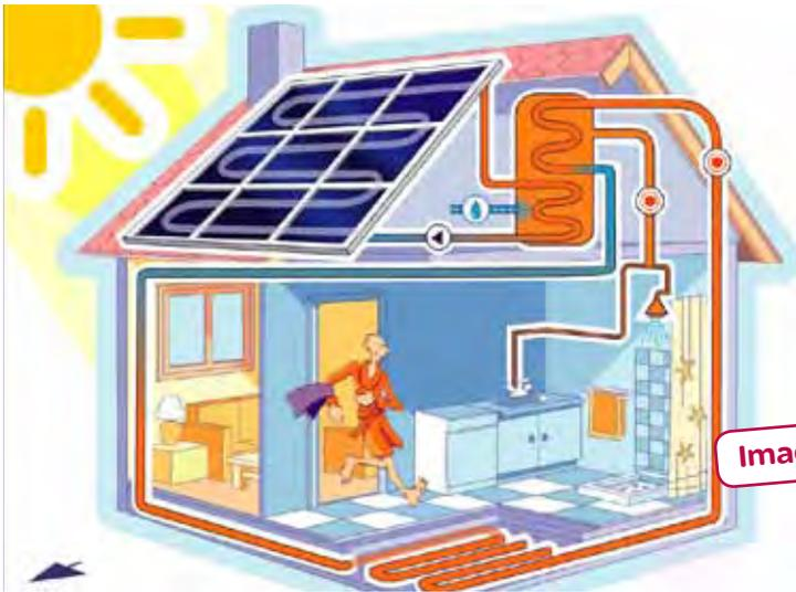
Le chauffe-eau solaire réagit comme un tuyau d'arrosage plein d'eau que l'on laisserait chauffer au soleil. Plus le tuyau est sombre, plus l'eau est chaude. Et si le tuyau est placé sous une vitre, l'eau peut même devenir bouillante.
